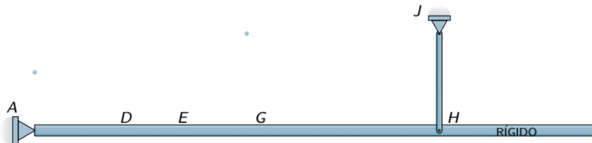
Dado que sólo existe una ecuación de la estática, y es necesaria solamente una barra para convertir este problema en un caso isoestático, se eligen 3 barras redundantes y sólo una perteneciente al sistema isoestático, tal como se observa en la siguiente tabla.
