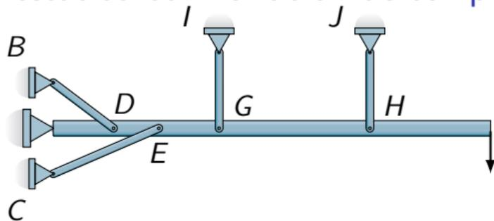
Se consideran los pasadores **B**, **C** e **I** como puntos con desplazamientos conocidos ( $\delta = 0$ ) para derivar la energía de deformación respecto a las fuerzas  $F_D$ ,  $F_E$  y  $F_G$  (independientes o redundantes). Aplicando el teorema de Castigliano para el pasador **B** ( $F_D$ ):
