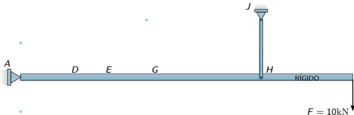
Dado que sólo existe una ecuación de la estática, y es necesaria solamente una barra para convertir este problema en un caso isoestático, se eligen 3 barras redundantes y sólo una perteneciente al sistema isoestático, tal como se observa en la siguiente tabla.
